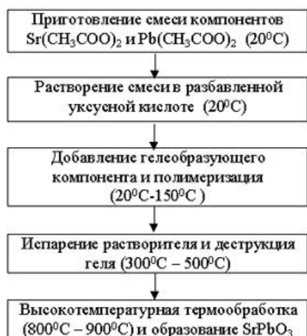
Рис 1. Схема золь-гель синтеза \text{SrPbO}_3 .
